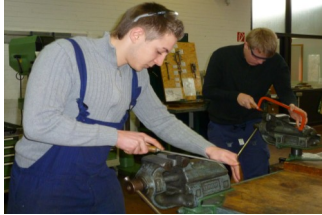
Fertigen eines Bauteils am Schraubstock
