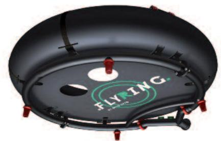
Der Flying besteht aus einer Handsteuerung, einem gegenüberliegenden Handgriff, einem aufblasbaren Schwimmer, einem beweglichen Y-Adapter sowie den vier Schubdüsen und den Rohrleitungen, die gleichzeitig als Unterbau der gesamten Konstruktion gelten.
