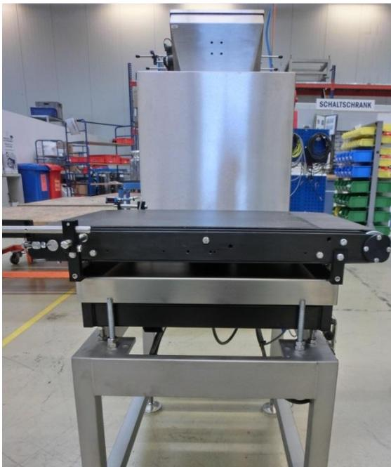
Die Aufgabe des Projekts bestand darin, die dynamische Kontrollwaage XE40 der Mettler-Toledo Garvens GmbH, welche eine Höchstlast von 40 Kilogramm wiegen kann, zu optimieren. Die Optimierung der dynamischen Kontrollwaage beinhaltete die Erhöhung der Stabilität und Steifigkeit des Bandkörpers. Eine Optimierung der De- und Montage der Antriebs- und Laufrolle sowie die Reduzierung der Motorvarianten waren umzusetzen. Weiterer Bestandteil war die Gewährleistung des Reversierbetriebs.
